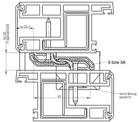
Lage- und Befestigung der Mittelstoßsicherung ist profilabhängig.
