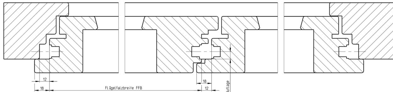
Schnitt mit 4 mm Falzlufte
