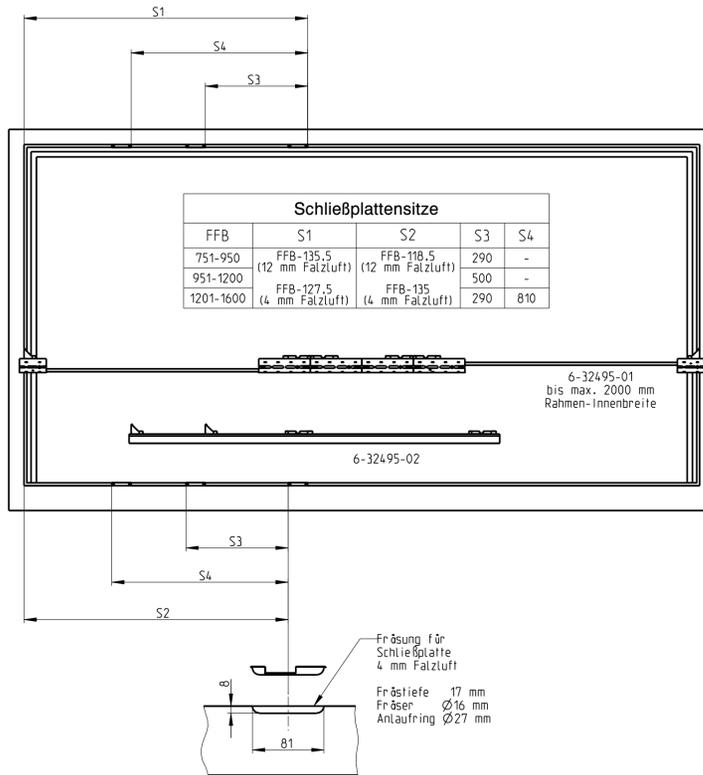
Schnitt mit 12 mm Falzlufte
