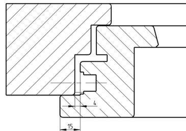
Variante für Mittelstoß mit Beschlagnutprofil P1380
