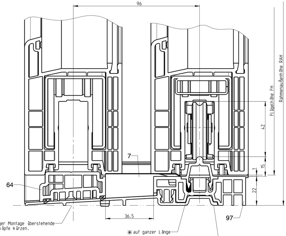
Bei der Montage des Elementes ist auf eine sorgfältige Unterfütterung auf ganz Länge der Bodenschwelle zum Baukörper zu achten.
