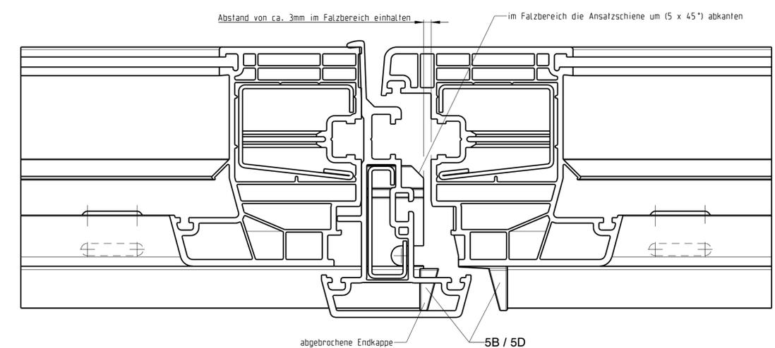
Abmessungen und Position der Entwässer- und Belüftungsschlitz sowie Bohrungen siehe Angaben des Profilsystemgebers
