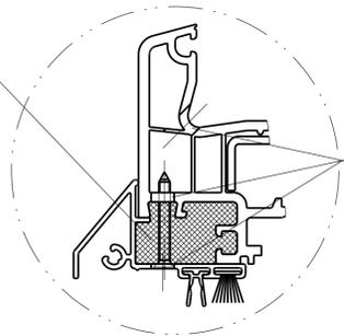
Abmessung und Position der Entwässerungs- und Belüftungsschlitze sowie Bohrungen siehe Angaben des Profilsystemgebers
