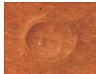
La maggiore elasticità consente allo strato di vernice di trattenere le particelle in modo più efficace. La superficie quindi si deforma meno e non si formano fessure.
