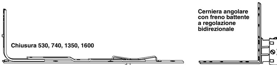
Cerniera angolare con freno battente a regolazione bidirezionale
