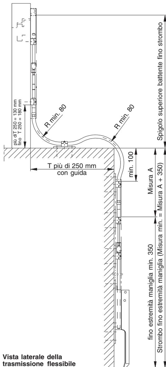
Vista laterale della trasmissione flessibile
